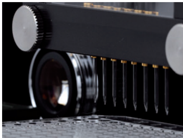
Kamera-basierte Online-Qualitätskontrolle beim sciFlexarrayer
