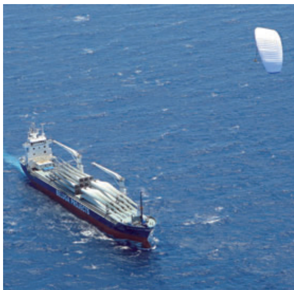
Die Antriebssysteme von SkySails senken die Emission von Schiffen um bis zu 35%.
