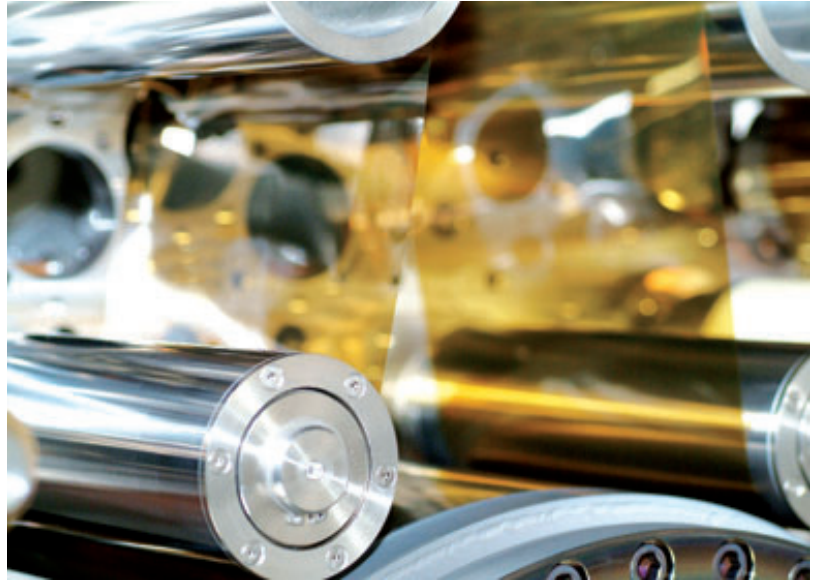
Beim Rolle-zu-Rolle-Verfahren von Solarion werden die Solarzellen in dünnen Schichten auf Folie aufgetragen.
