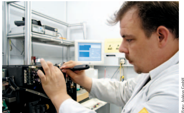
Justage und Inbetriebnahme der Lasercordereinheit für digitale Fotobelichter
