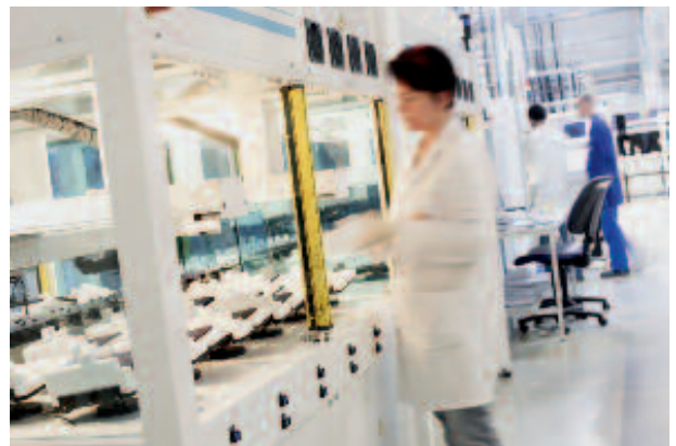
Der letzte Produktionsschritt: Der Klassierer, eine vollautomatische Sortieranlage, in der die fertigen Solarzellen gescannt, unterschiedlichen Qualitätsklassen zugeordnet und in die im Vordergrund sichtbaren stoßfesten und wiederverwendbaren Styroporverpackungen einsortiert werden.
